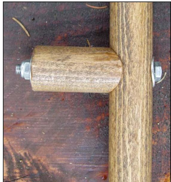
À cette hauteur, percer un trou de 6 mm en travers du bâton ainsi que dans la longueur au centre du petit bout de noisetier. Vous y passerez le boulon M6 au travers des deux trous avec les rondelles à chaque extrémité et serrez bien le tout avec l'écrou.
