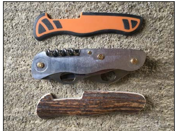
Une des plaquettes en bois de cerf à l'identique de l'ancienne en matière synthétique
