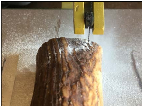
Découpe du bois de cerf pour former les deux plaquettes
