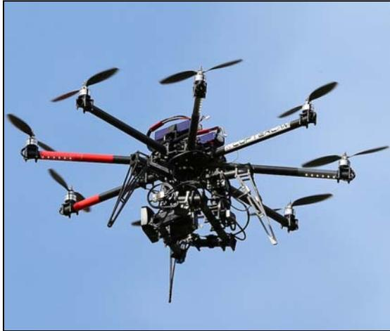
Cette solution est onéreuse et ne rentre pas dans la catégorie des "jouets". Elle n'est pas pour toutes les bourses. Mais cette solution a l'avantage que l'engin volant est équipé d'une caméra infrarouge (non pas seulement d'un capteur infrarouge) et qu'une liaison de communication livre une image directe à l'utilisateur. Le taux de réussite pour retrouver les animaux est plus important.
