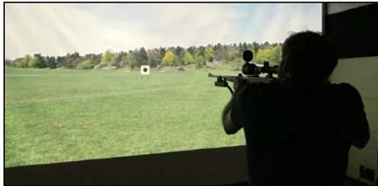
Le but du simulateur est de s'améliorer dans le tir en mouvement. Le système permet l'analyse de tous les facteurs du coup de feu en mouvement. Les éléments analysés sont par exemples: la vitesse de visée; la vitesse de déplacement du canon; le mouvement du canon; etc... Tous ces paramètres font que la progression pour un tir précis est rapide car les erreurs et les mouvements parasites peuvent être corrigés directement après le lâcher du coup de feu.
