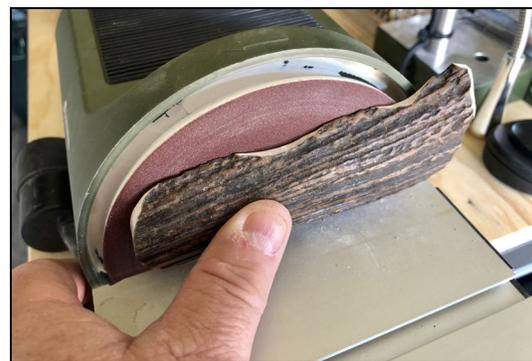
L'assemblage du couteau se fait avec deux vis incrustées dans le manche. La finition du manche s'est faite à la lime et au papier de verre. Et le tour est joué. Fixé à la ceinture, celui-ci m'accompagnera lors des prochaines sorties à la chasse...
