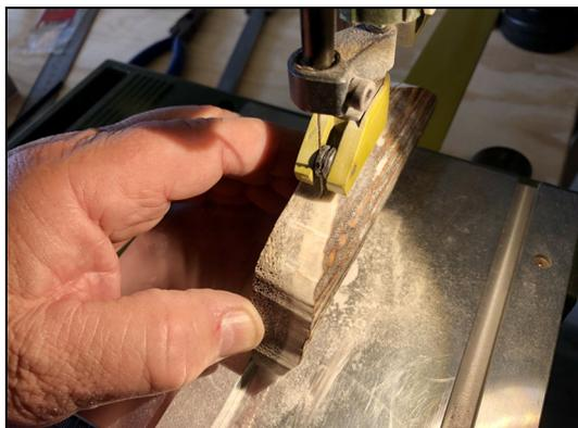
Le dégrossissage s'est fait soigneusement à la scie. Et pour obtenir une surface parfaitement plate des deux parties du manche, c'est la ponceuse qui a fait le travail (attention les doigts).
