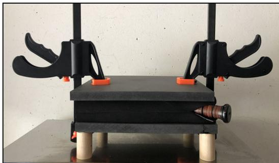
La plaque de *Kydex* passera au four (160-165°C) et deviendra malléable et le restera pour quelques minutes. On va aussitôt emballer l'outil qui recevra son fourreau et on met le tout dans la presse. Bien tendre les serre-joints et attendre 15 minutes, le temps que le *Kydex* retrouve sa température ambiante.
